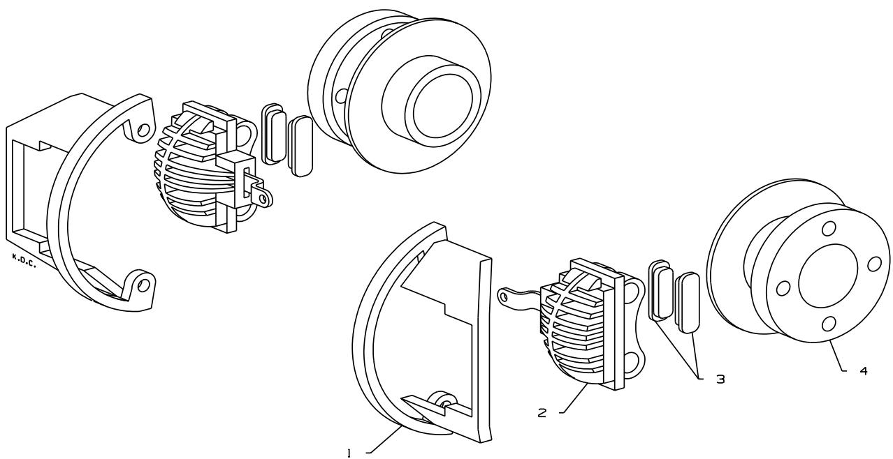
**CALIPER BRAKE ASSEMBLY****LIST OF PARTS**
